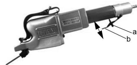
Fig. 3 : Déverrouillage soupape à levier DL 40
