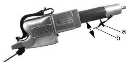
Fig. 3: sbloccare la valvola a leva DL 40
