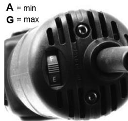
Fig. 6 : Réglage de la vitesse de rotation
