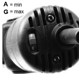
Abb. 6: Drehzahlregulierung
