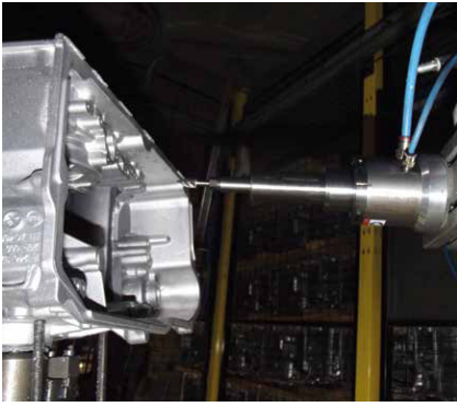
Bild 1: Beispiel, bei dem die Spindel fixiert ist und der Roboter das Bauteil führt.
