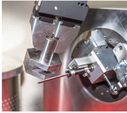
Bild 2: Entgratzelle mit einem Druckluftfeiler.
