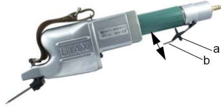
Şekil 3: DL-40 mandallı valfinin emniyetinin açılması
